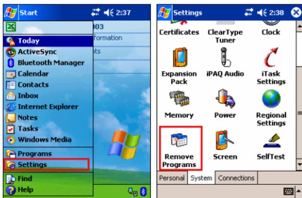
Figura 1. Disinstallazione del controllore
