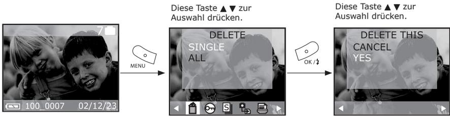
Drücken Sie die Taste OK zum Bestätigen, falls Sie den Löschvorgang annullieren wollen, wählen Sie Cancel (Annullieren) oder drücken Sie die Menütaste.
