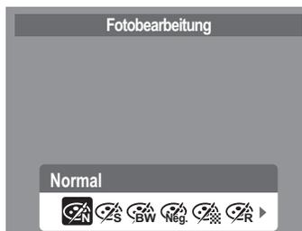
5. Wählen Sie mit den Tasten ◀ und ▶ eine Option aus. Synchron zum Navigieren durch die Auswahlmöglichkeiten wird der jeweilige Effekt auf die Bildvorschau angewendet und entsprechend angezeigt.
