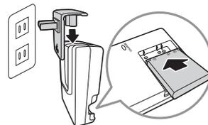
1. Setzen Sie die Batterie in das Ladegerät ein, wie in der Abbildung gezeigt.
