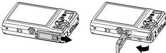
3. Stecken Sie den Akku so in das Fach, dass die Kontakte in Richtung des Kamerainneren zeigen.
