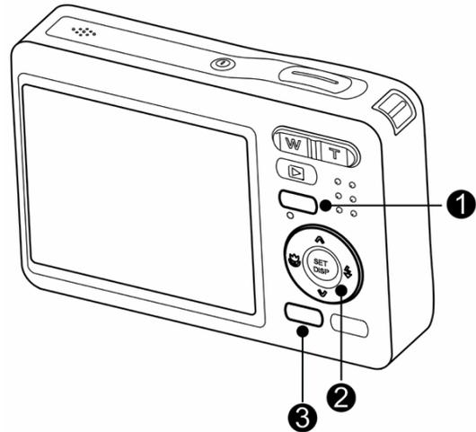
**3****Drücken Sie die Taste ▲ oder ▼(❷), um Eins auszuwählen und anschließend die Taste SET(❸).****4****Drücken Sie die Taste ◀ oder ▶(❷), um das Bild auszuwählen, das Sie löschen möchten.****5****Drücken Sie die Taste SET(❷), um den Vorgang abzubrechen.**
