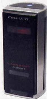
◀ **Elegantes Gehäuse:** Aus dem oberen Fenster strahlt der Laser das Tastatur-Bild aus, das mittlere und untere Fenster dienen dem Infrarot-Sender und -Empfänger.
