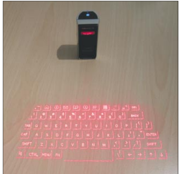
▲ Kleines Gerät, große Tastatur: Die Celluon LaserKey ermöglicht das Tippen auf jeder ebenen Oberfläche und steht mit dem Pocket-PC per Bluetooth in Kontakt.
